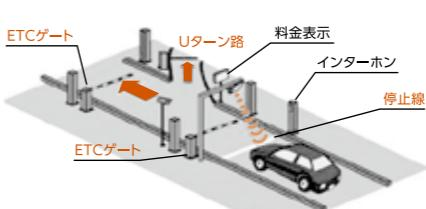
そんな駿河湾沼津サービスエリアに開通する駿河湾沼津スマートICは、東京方面・名古屋方面に出入りできる全方向型のもので、ETCを搭載した車両のみが通行できる専用レーンです。
