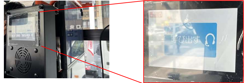
通常連絡と緊急連絡をするための、ボタンが表示
