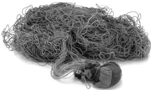
麻糸のメジナワ 木綿布の中におが屑とツリが入っている
