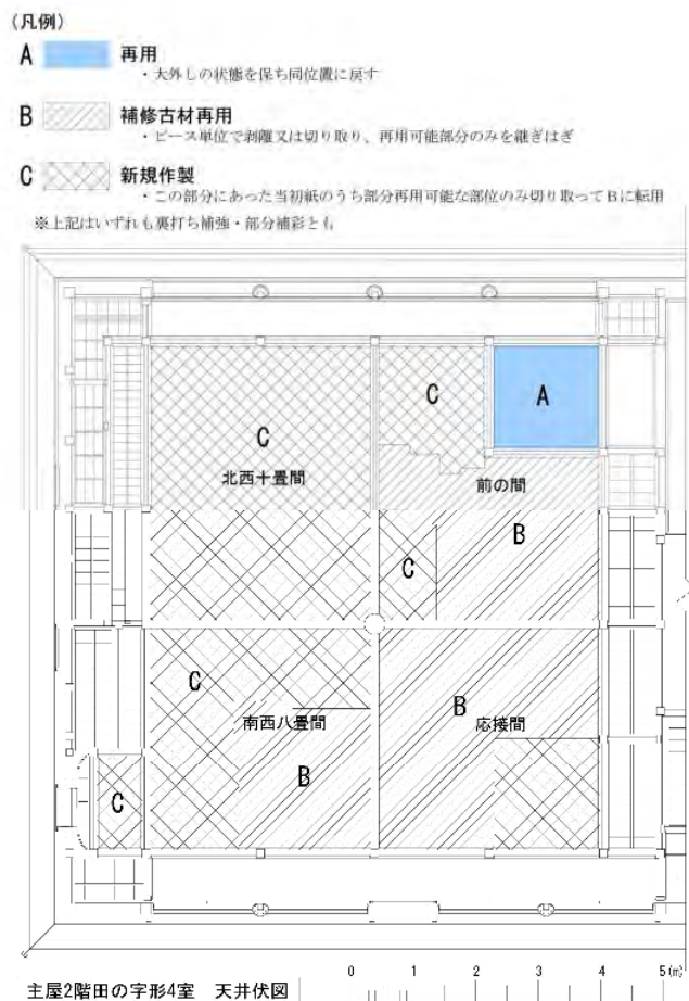
図3-2-12-1 模様印刷洋紙張付天井補修区分
