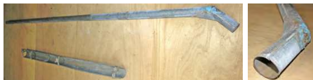
写真4-4-11-5 堅樋受け金具の痕跡
