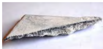
写真 4-4-4-23 ミセ西面擬石塗 当初仕上げ片
