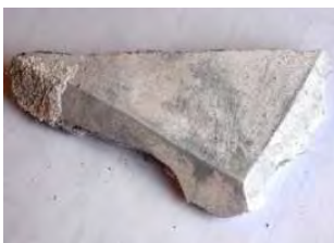
写真 4-4-4-23 ミセ西面擬石塗 当初仕上げ片
