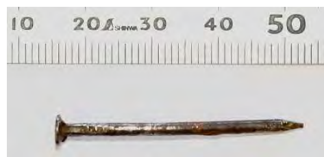
写真 4-4-2-3 明治15年頃丸釘（時代A）拡大
