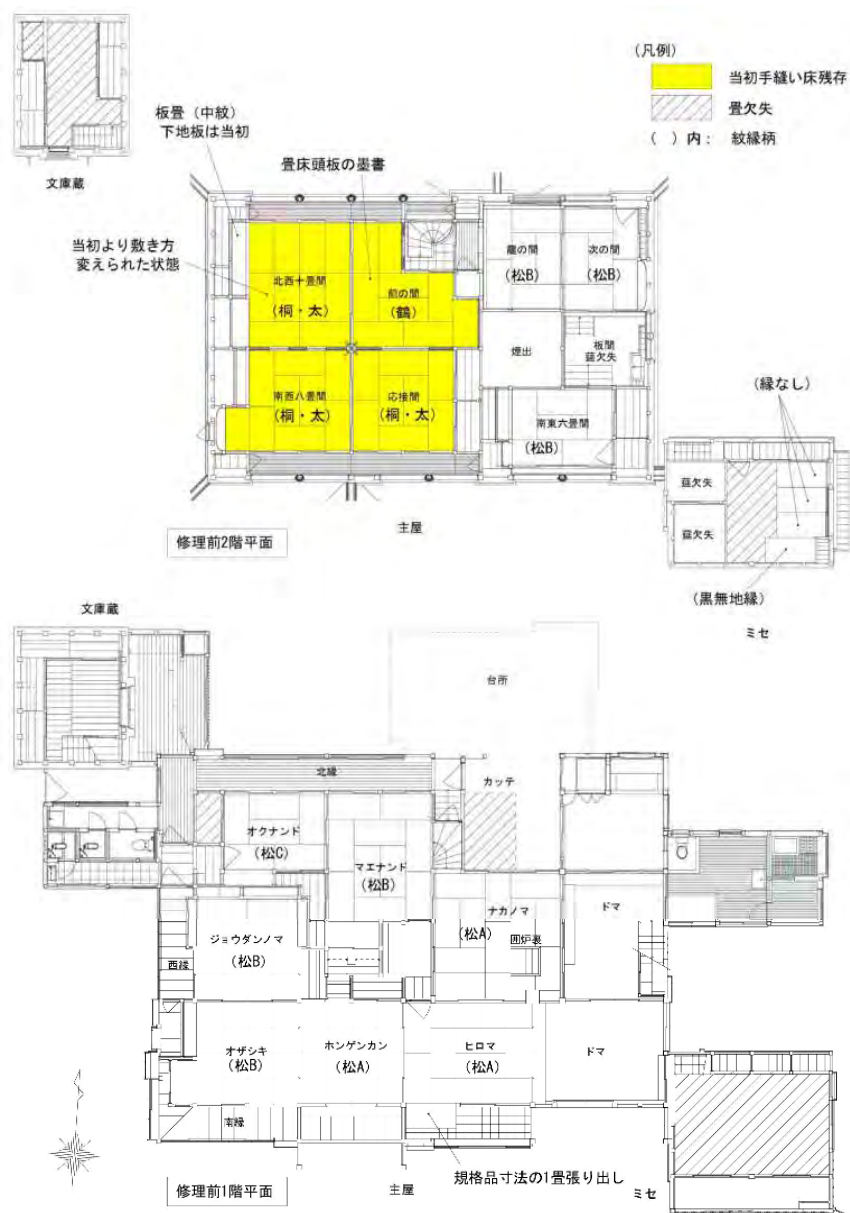
図4-4-6-1 修理前畳残存状況
