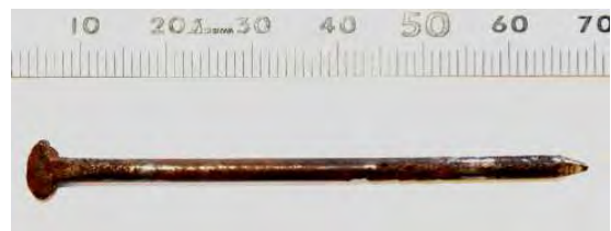
写真 4-4-2-4 明治後期～末丸釘（時代B）拡大
