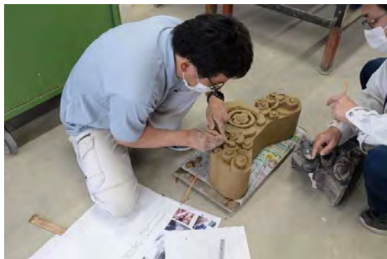
主組28 鬼瓦生型製作状況
