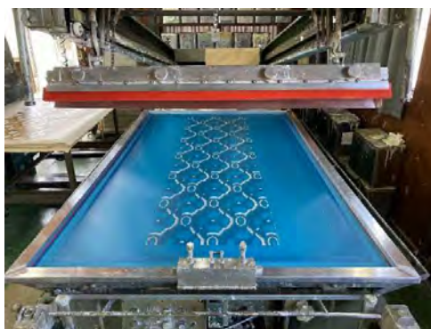
主組77 2階西半4室天井紙（模様印刷洋紙） シルクスクリーン印刷状況
