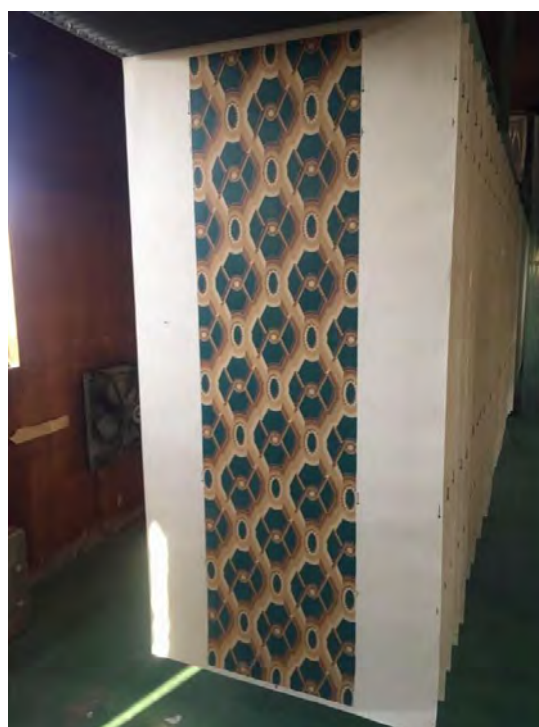
主組78 2階西半4室天井紙（模様印刷洋紙） シルクスクリーン印刷乾燥状況
