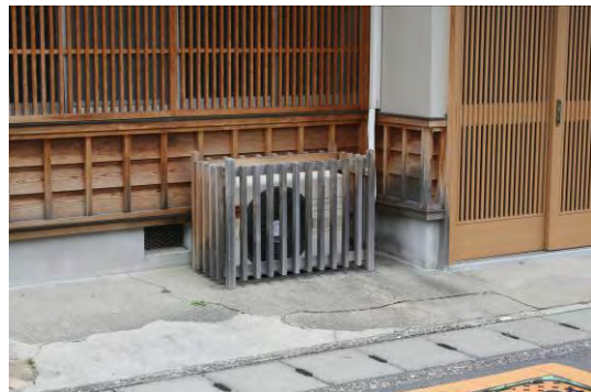
建物の雰囲気と調和した色彩や素材の囲いを設け、建物の印象を乱さないようにしている。
