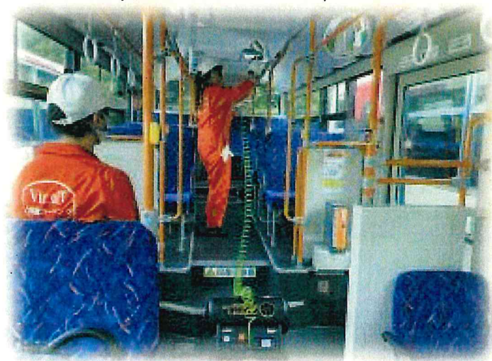
↑ 車両の光触媒コーティング
