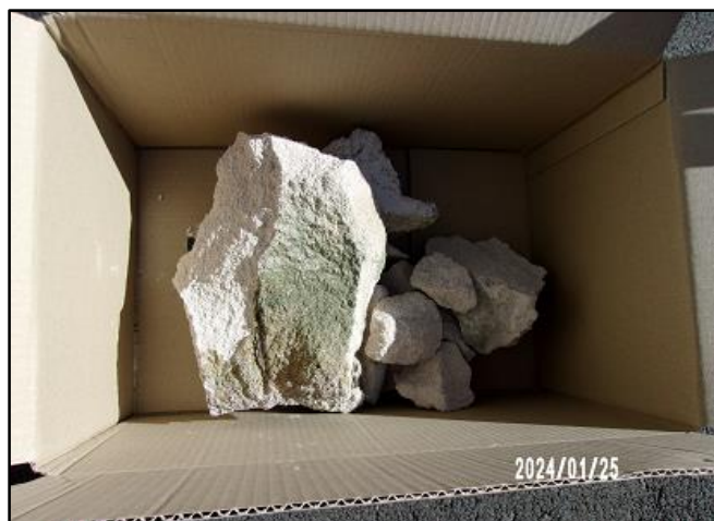
道路に落下した破片 30cm×30cm
