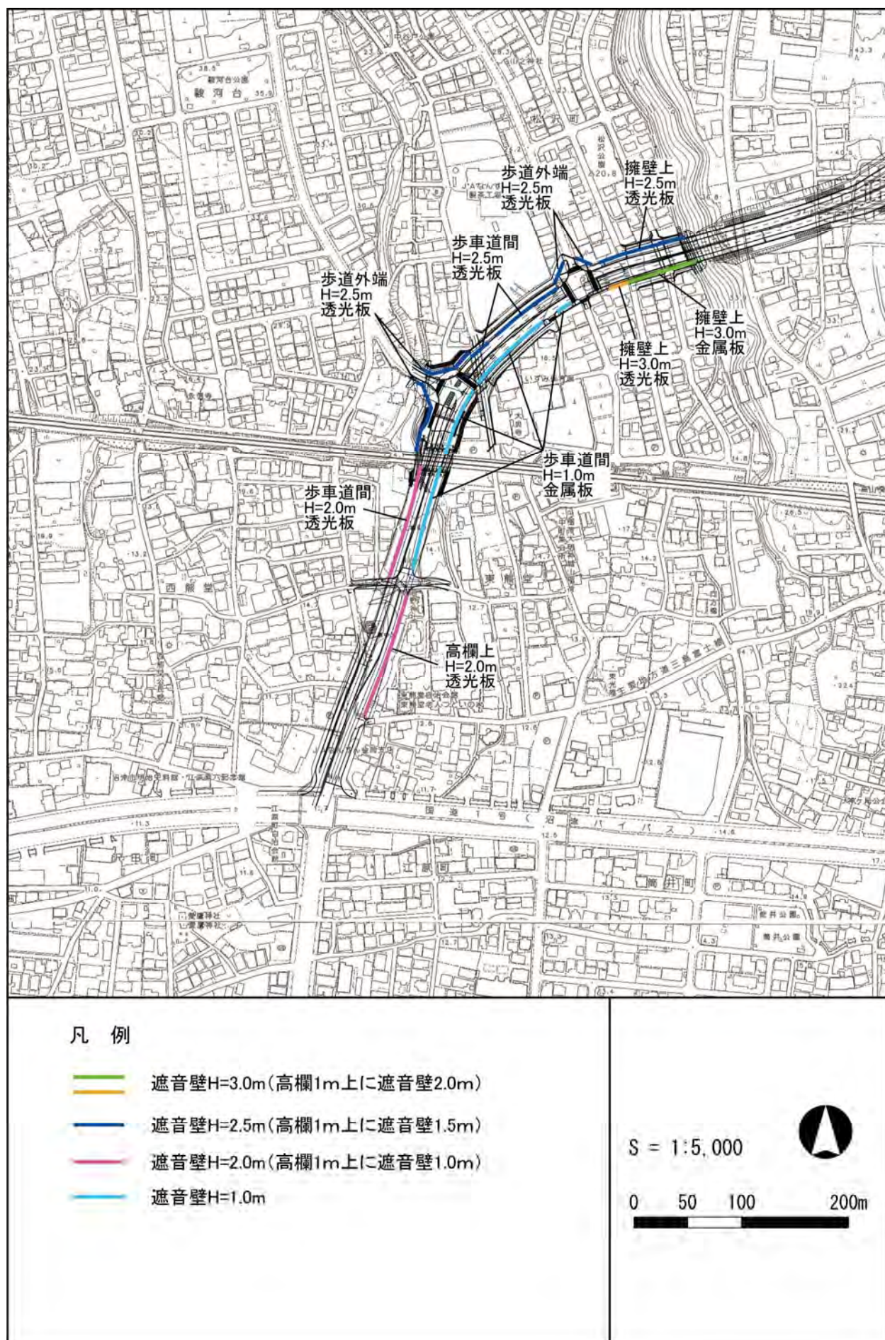
図6 遮音壁設置範囲図（密粒舗装）
